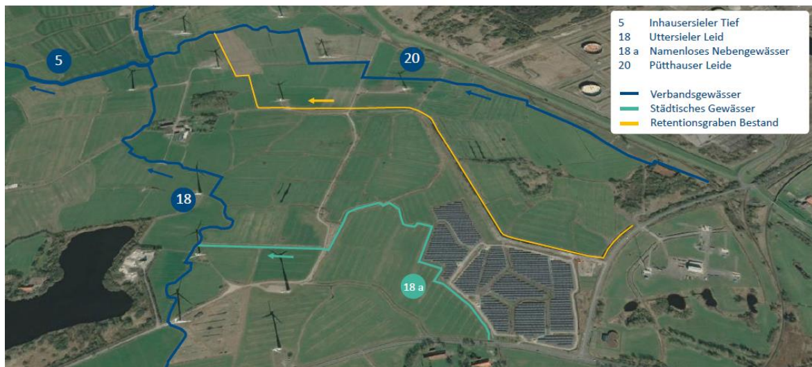
Abbildung 11 Entwässerung im Bestand (bf gmbH Entwässerungskonzept) 20
